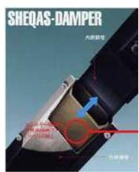
地震エネルギーを熱エネルギーに変えて揺れを吸収するシステム、「シーカス」。
